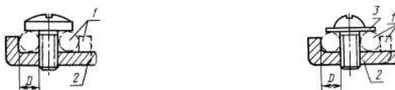
Зажимы, не требующие применения прокладки, прижимной пластины или специальной прижимной детали
