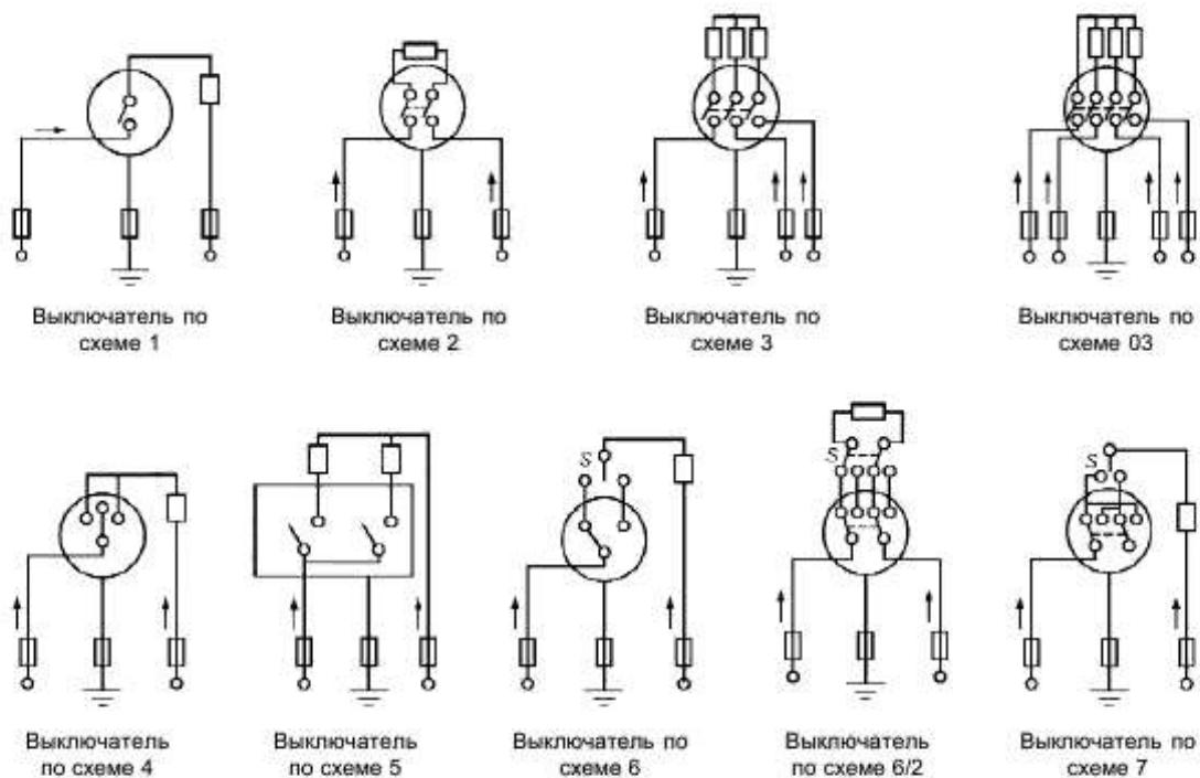
Стрелки, показывающие соединение фазных проводников, приведены исключительно в качестве примера.
