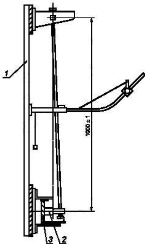
1 — рама; 2 — образец; 3 — основание для крепления образца
