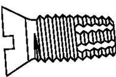
Рисунок А.7 — Самонарезающий режущий винт
