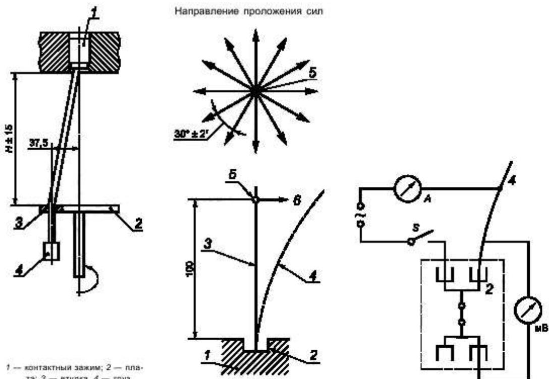
1 — контактный зажим; 2 — пластина; 3 — втулка; 4 — груз
