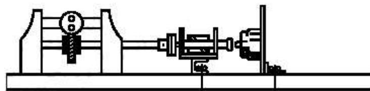
Устройство для выключателей с балансиром и кнопочных выключателей
